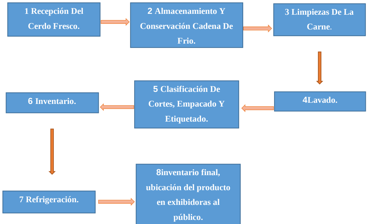
Figura 11 Diagrama De Flujo De La Línea De Producción De Carne De Cerdo
