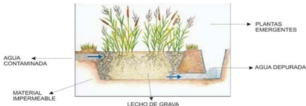
Figura 2. Diagrama simplificado de un humedal artificial de flujo subsuperficial.
