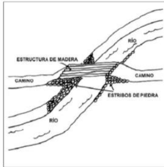
Figura 6. Puente tradicional de madera
