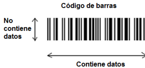
Figura 2.2. Forma de almacenamiento en un código de barras lineal. Figura tomada de [HERNANDEZ 04].
