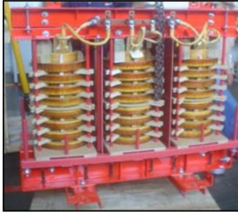
Figura 9. Transformador piloto Suntec 89 .
