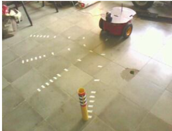
Figura 57. Fotografía de una marca a 1.05 m de la cámara para calcular el ángulo de visión del sensor de visión.
