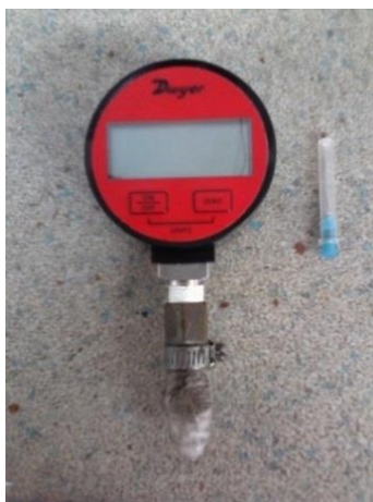
Figura 4.5 Manómetro empleado en el montaje
