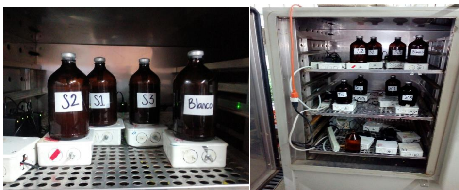
Figura 4.4 Reactores ubicados en la incubadora del laboratorio de lodos
