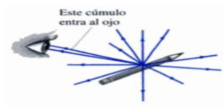
Fig 3. El modelo de Rayos Asociado al Fenómeno de la Visión. Los rayos de luz provienen de un punto individual de un objeto; se muestra como un pequeño cúmulo de rayos que emanan desde un punto entran a los ojos de una persona.
