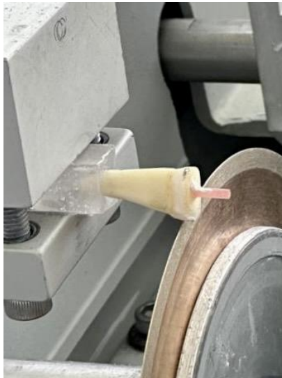
IMAGEN 7: Equipo IsoMet® 1000 Precision (Buehler) y disco de diamante (Isocut Wafering Blade-CBN HC de 7 pulgadas de diámetro)
