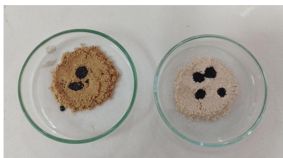
Figura 3. Evidencia de la coloración azul intensa tras la adición del reactivo de Lugol en muestras de almidón extraído de cáscara (izquierda) y tallo (derecha) de plátano macho
