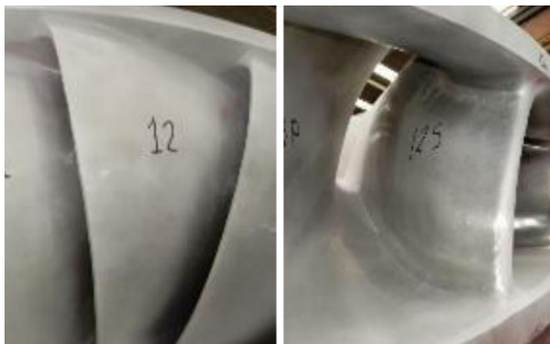
Figura 6.4.2.1.1. Ensayo de tintas penetrantes en el rodete.
