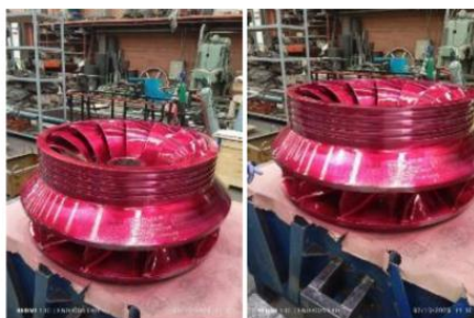
Fotos 57 y 58. Fotos representativas de inspección mediante líquidos penetrantes.
