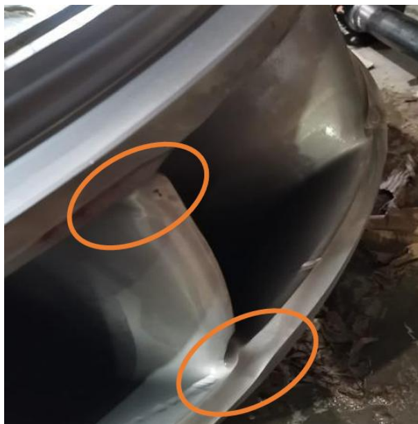
Figura 6.1.1.3. Desgaste por abrasión en zona intradós rodete.
