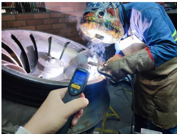
Figura 6.3.2.1. Intervención soldada por medio de SMAW con soldador calificado.
