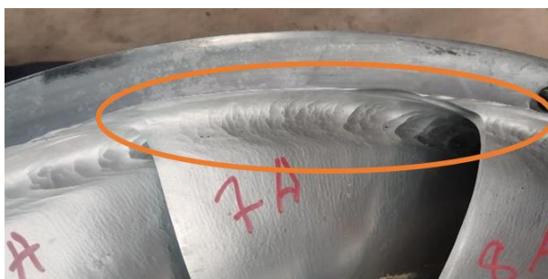
Figura 6.1.1.2. Desgaste por abrasión en zona extradós rodete.
