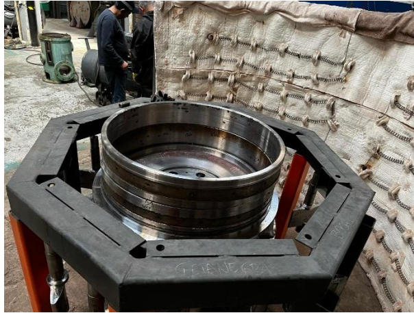
Figura 6.3.2.2. Momento previo al alivio de tensiones.
