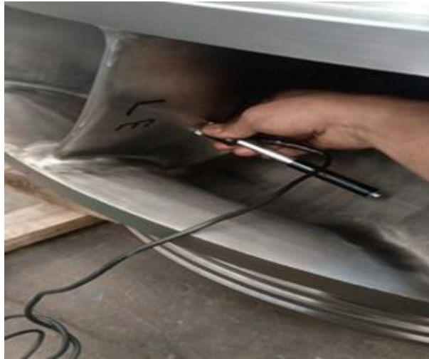
Figura 6.4.3.1. Muestreo de durezas en zona extradós del rodete.
