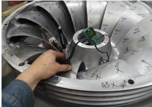
Figura 6.1.3.1. Muestreo de durezas en zona extradós del rodete.
