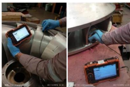
Fotos 59 y 60. Fotos representativas de inspección mediante ultrasonido.
