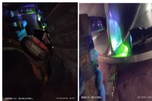
Fotos 55 y 56. Fotos representativas de inspección mediante partículas magnéticas.
