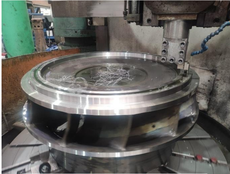
Figura 6.3.4.1. Mecanizado final del rodete.
