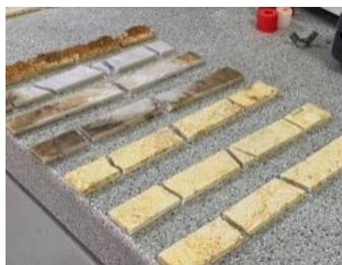
Figura 33. Resultados del ensayo de resistencia a la flexión en probetas rectangulares, obtenidas mediante fusión térmica del remanente poliéster ópalo a varias temperaturas
