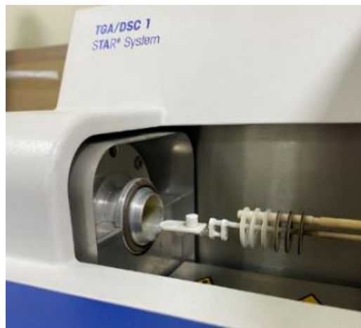
Figura 18. Equipo Mettler Toledo para ensayo de TGA/DSC. La muestra de poliéster ópalo se ha dispuesto en un crisol de alúmina para ser calentada bajo atmósfera inerte desde 25 hasta 900°C.
