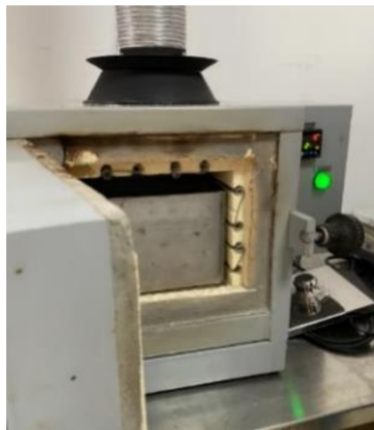
Figura 21. Fusión térmica de las muestras de poliéster ópalo en molde de acero calentado en horno mufla a tres temperaturas diferentes.
