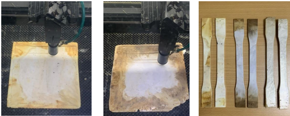
Figura 25. Extracción de probetas tipo hueso mediante corte láser a partir de la placa obtenida por fusión térmica del poliéster ópalo
