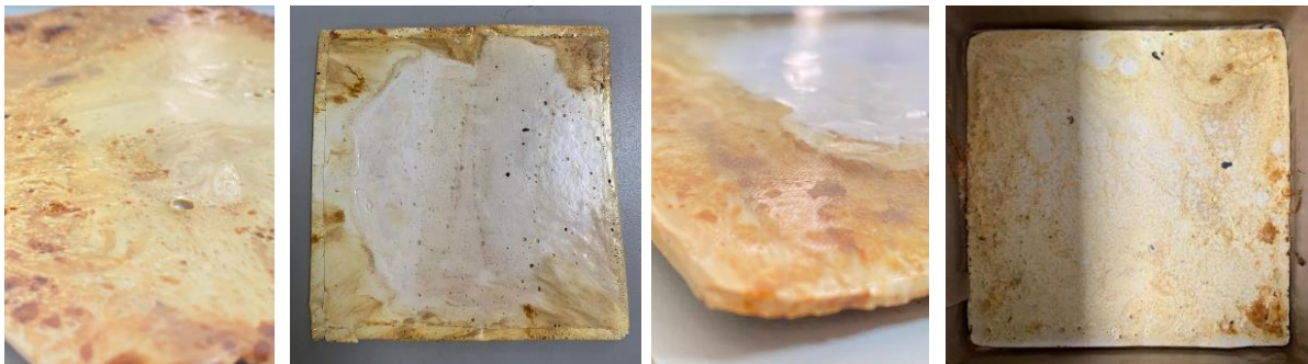
Figura 23. Aspecto, textura y coloración de la placa obtenida mediante fusión térmica de las muestras de poliéster ópalo a 310°C.
