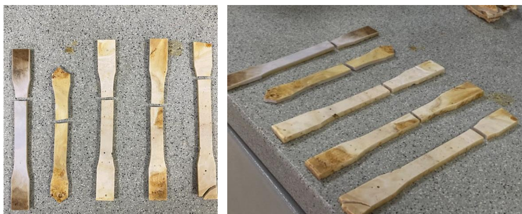
Figura 29. Resultados del ensayo de resistencia a la tensión en probetas tipo hueso, obtenidas mediante fusión térmica del remanente poliéster ópalo a varias temperaturas.
