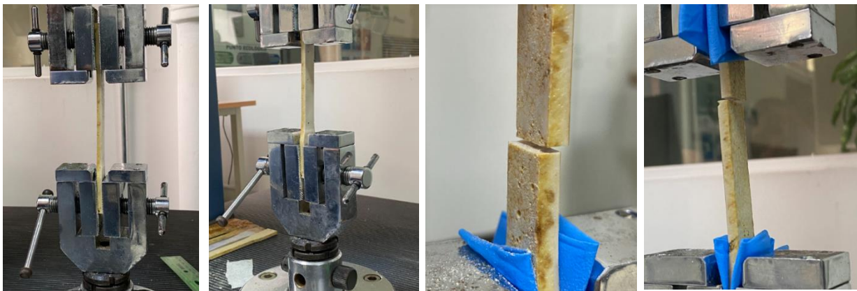
Figura 28. Probetas rectangulares tipo hueso sometidas a ensayos de tensión según la norma ASTM-D638.
