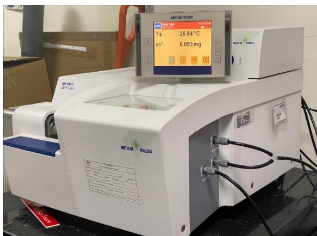
Figura 18. Equipo Mettler Toledo para ensayo de TGA/DSC. La muestra de poliéster ópalo se ha dispuesto en un crisol de alúmina para ser calentada bajo atmósfera inerte desde 25 hasta 900°C.
