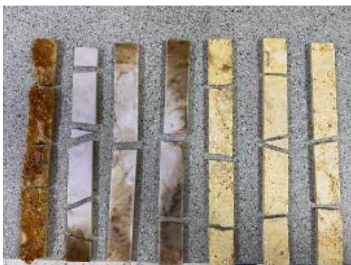
Figura 33. Resultados del ensayo de resistencia a la flexión en probetas rectangulares, obtenidas mediante fusión térmica del remanente poliéster ópalo a varias temperaturas
