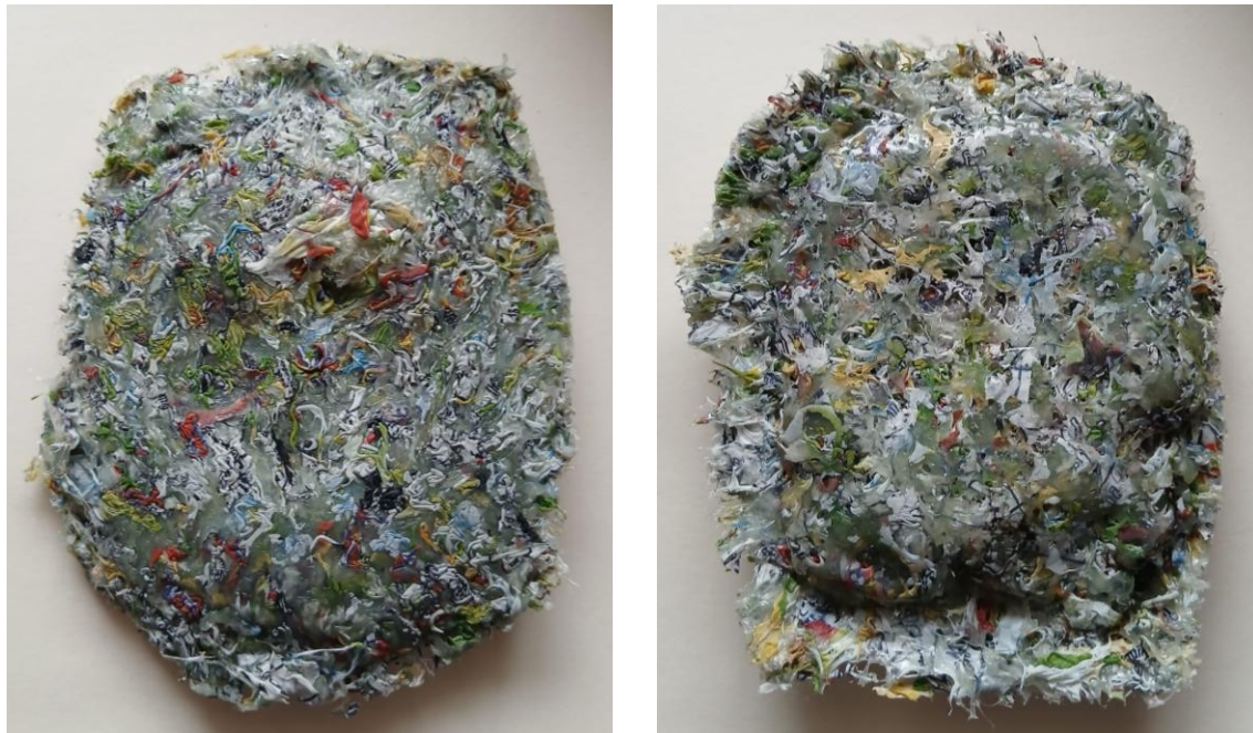
Figura 34: Lamina resultado de primer acercamiento del material con PEBD triturado.
