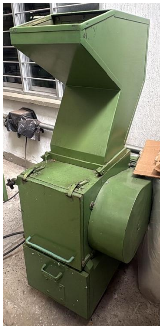
Figura 32: Molino de cuchillas para tritución del PEBD de Power Milk.
