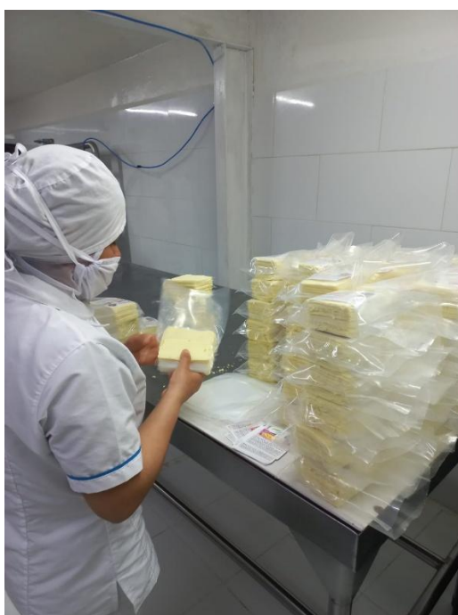
Figura 20: Empaque vinipel, vacío y separadores en Power Milk.
