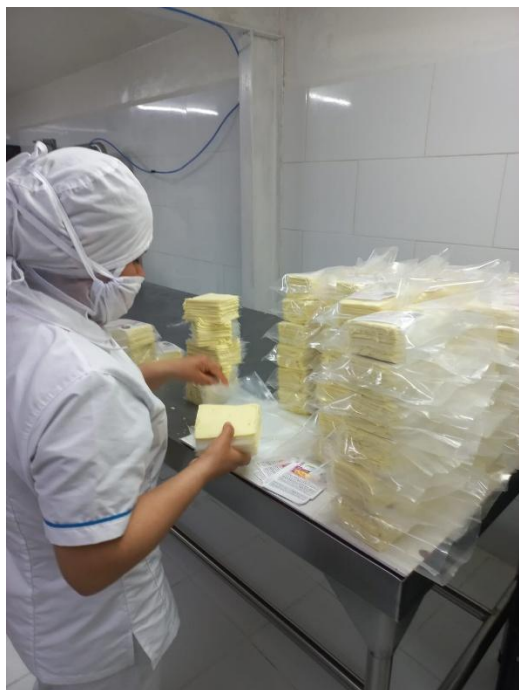
Figura 20: Empaque vinipel, vacío y separadores en Power Milk.
