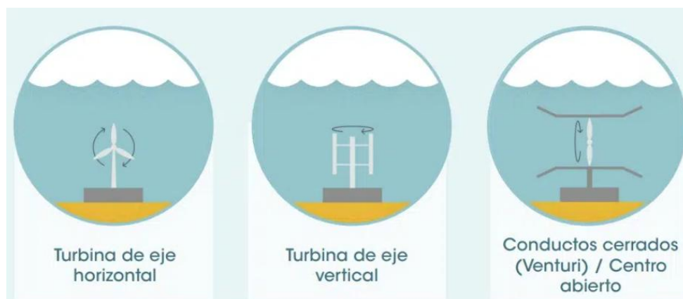
Figura 4. Turbinas de corriente. Tomado de OVACEN, 2025
