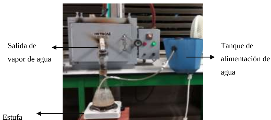
Figura 3 Montaje del sistema de producción de vapor
