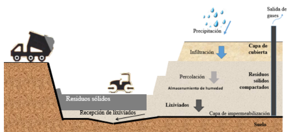
Figura 1. Producción de lixiviados en un relleno sanitario.
