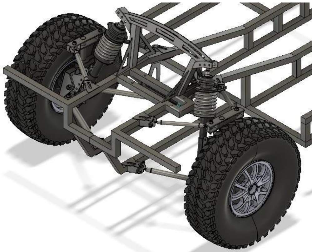
Fig. 33. diseño de la suspensión y su interacción con el chasis.
