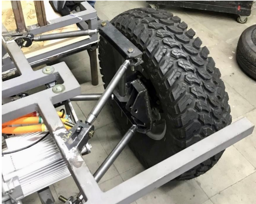
Fig. 85 Primer montaje realizado de la suspensión - rueda izquierda.
