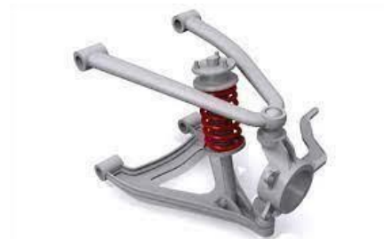
Fig. 3 Suspensión McPherson tipo doble horquilla. Tomada de ( https://segurovehicular.net/macpherson-vs-suspension-de-doble-horquilla-pros-y-contras/ )
