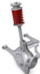
Fig. 4 Suspensión McPherson tipo puntal. Tomada de ( https://segurovehicular.net/macpherson-vs-suspension-de-doble-horquilla-pros-y-contras/ ) La doble articulación en el enlace de control superior o inferior proporciona ventajas en el
