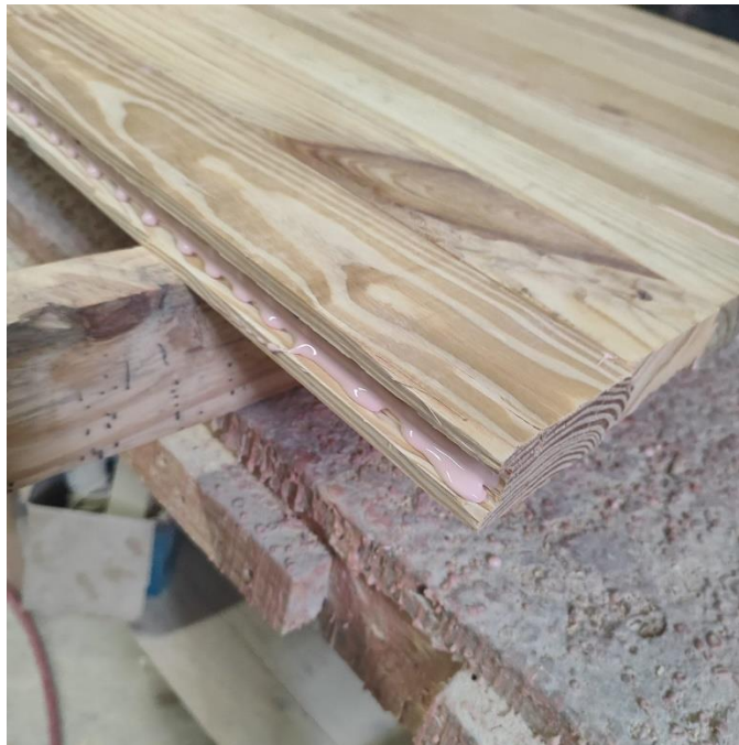
Ilustración 8. Proceso de machimbrado, Ecodeco (fotografía) Muñoz A (2025)
