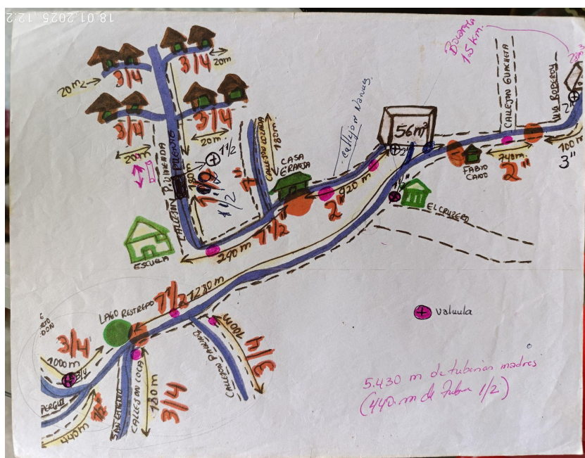
Figura 23. Diagrama de la red de distribución del acueducto. Fuente: ASOVEAGUAS, 2024.
