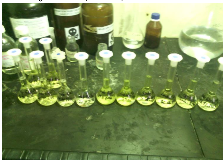
Anexo 3. Ensayos de digestión de la muestra para la determinación de metales en el lodo
