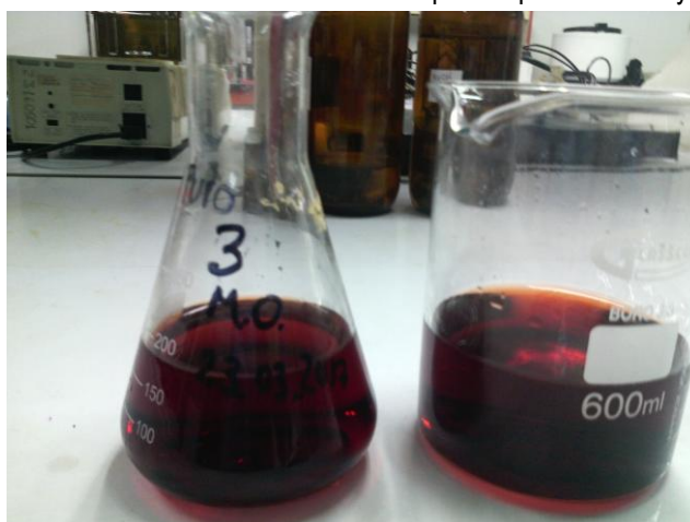
Anexo 5. Determinación de Materia Orgánica en la muestra de lodo
