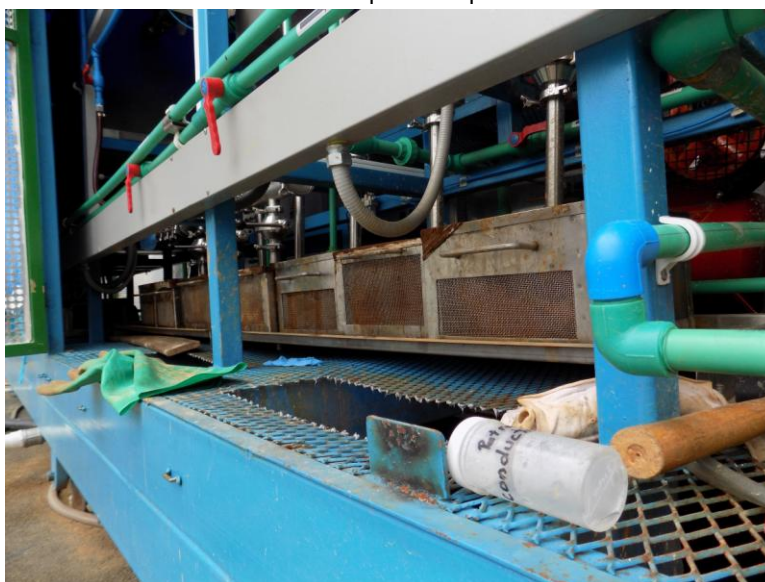
Anexo 11. Ubicación de las canastillas para recolección de lodo
