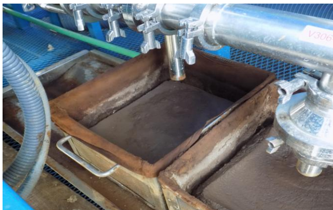
Figura 7. Muestra de lodo recolectada del primer sedimentador
