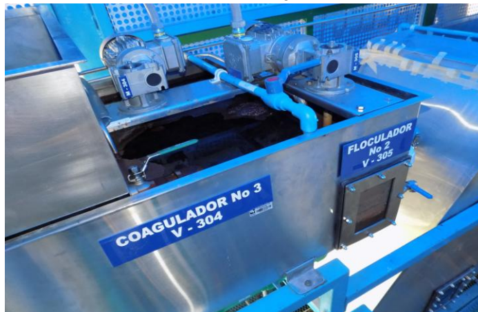
Anexo 6. Coagulador No. 3 y Floculador No.2 Planta ELECTROFLOX®
