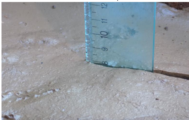
Anexo 12. Medición de los niveles de lodo en las canastillas de recolección
