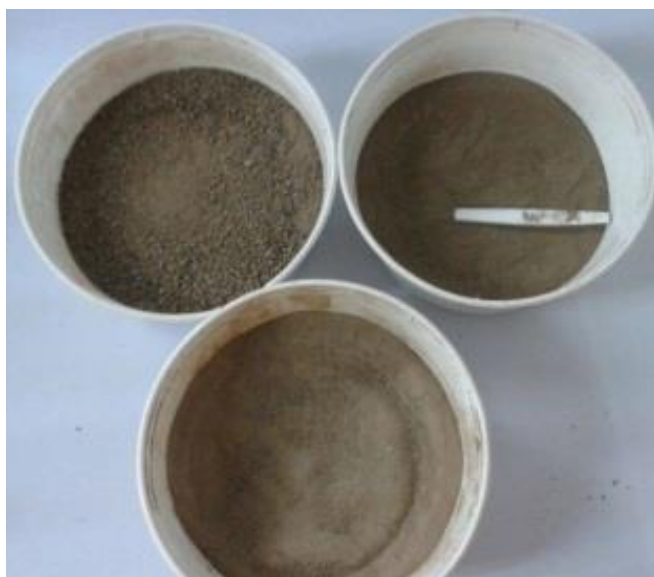
Figura 8. Muestra de lodo secada a 105^{\circ}\text{C} durante una hora
