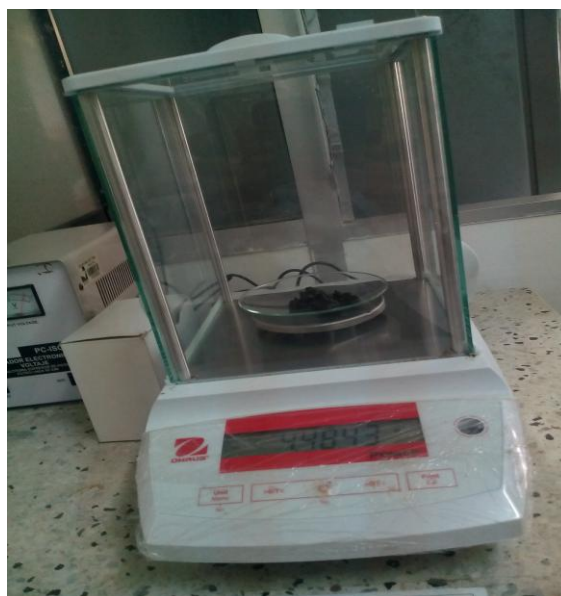
Anexo 4. Balanza Analítica con muestra de lodo empleada para los ensayos de laboratorio
