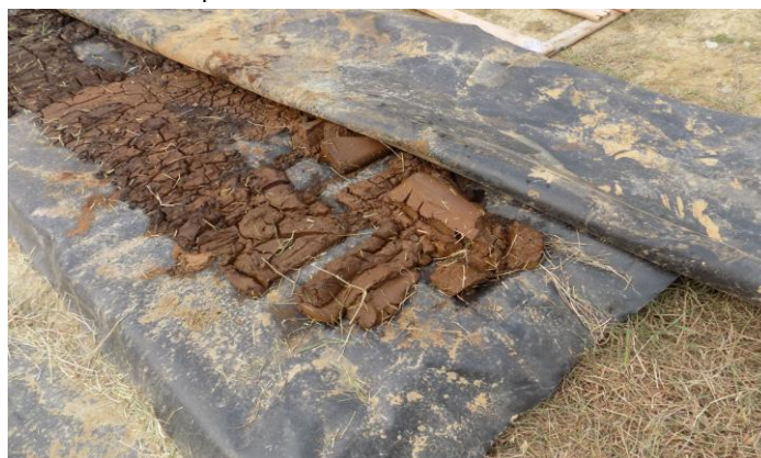
Anexo 9. Muestra de lodo secada a temperatura ambiente en el relleno sanitario
