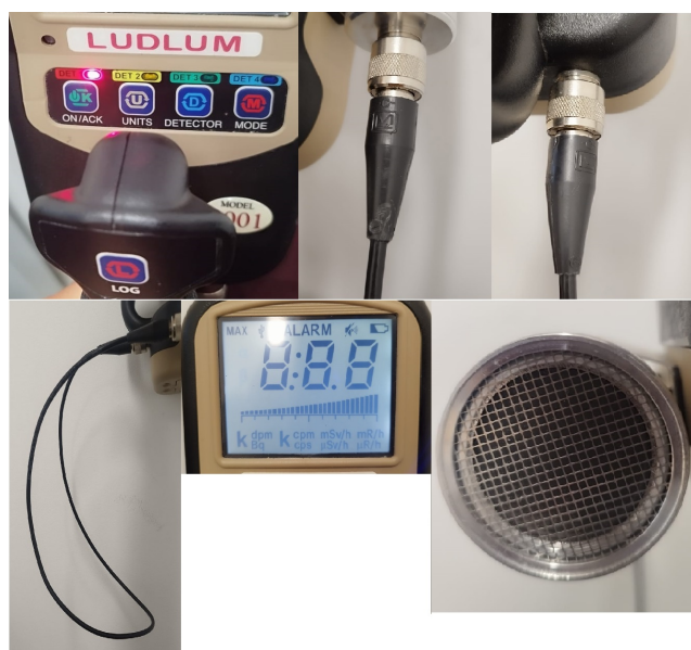
Figura 5.2: Verificación de funcionamiento del equipo Ludlum Model 3001
