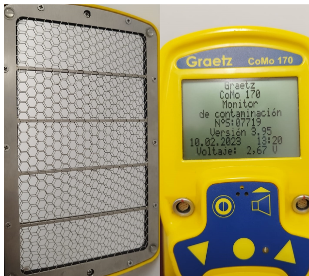
Figura 5.1: Verificación de funcionamiento del equipo Graetz CoMo-170
