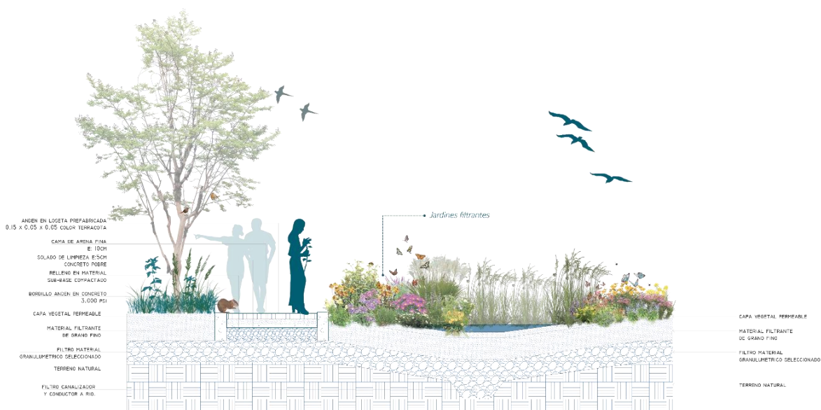
Figura 42 Corte a detalle sendero principal
