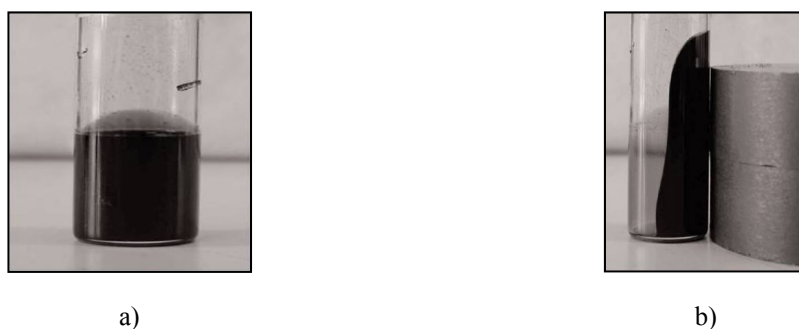
Figura 26. Ferrofluido de \text{Co}_{(1-x)}\text{Zn}_x\text{Fe}_2\text{O}_4 sintetizado por coprecipitación química a) sin campo aplicado y b) con campo aplicado.
