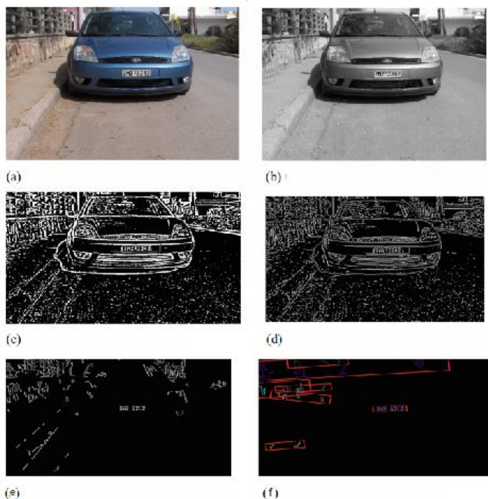
Figura 12: Detección de la Licencia vehicular, (a). Imagen de entrada obtenida a partir de una fotografía tomada, (b). Conversión de la imagen en escala de grises mediante la utilización de filtros (c). Salida del umbral adaptativo, (d), Imagen luego de pasar por la jerarquía externa de contornos (e). Imagen luego de pasar por la jerarquía secundaria de contornos, (e). localizaciones de los contornos que tienen la posibilidad de tener la licencia vehicular. (Chithra & Prashanthi, 2017).
