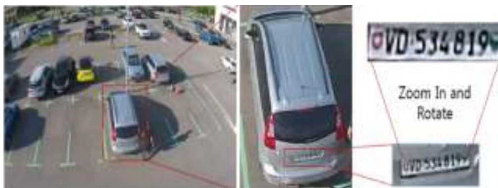
Figura 9: Localización de las áreas de interés y localización del vehículo, donde se realiza un zoom y una rotación de manera manual para permitir que el algoritmo de extracción de caracteres funcione correctamente.(Gaszczak y col., 2011).
