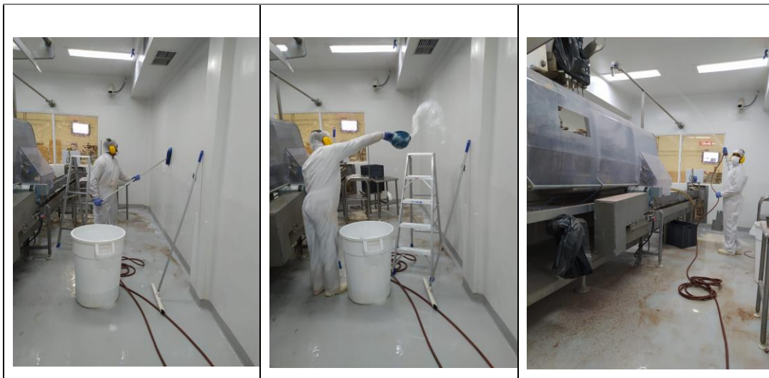
Figura 21: Lavado Línea Mespac
