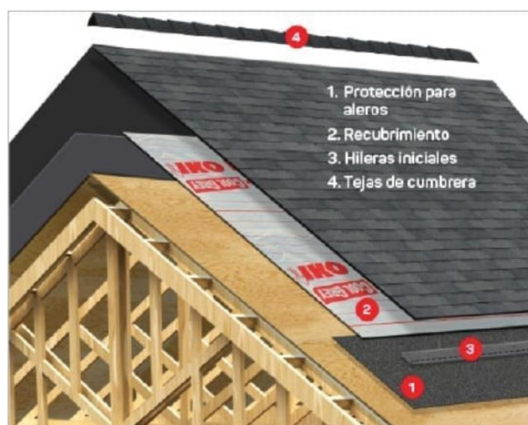
Figura 32. Cubierta en asfalto.
