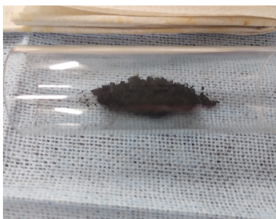
Figura 4.7: Catalizador de zeolita y níquel después de la calcinación a 600 °C.
