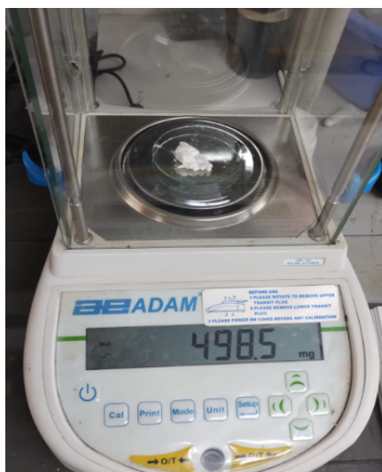
Figura 4.1: Pesaje de 500 mg de zeolita como soporte del catalizador.
