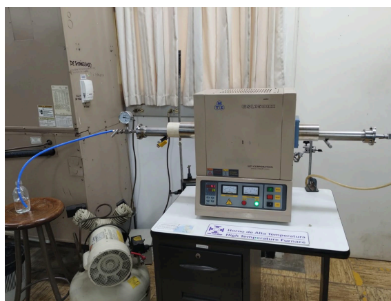
Figura 4.6: Sistema de calcinación en horno tubular con atmósfera de nitrógeno.
