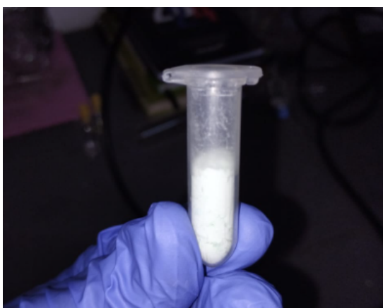
Figura 4.5: Secado completo de la mezcla de zeolita y acetato de níquel en horno durante toda la noche.
