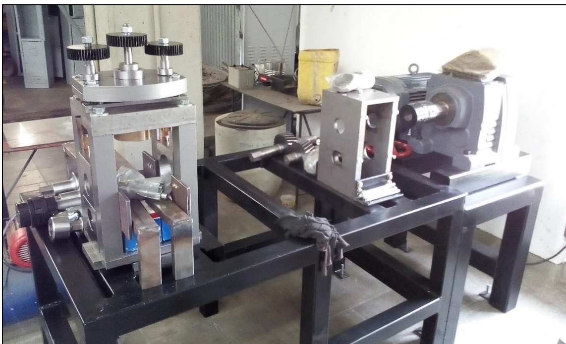
Ilustración 63 Fotografía del pre ensamble general del equipo de laminación.
