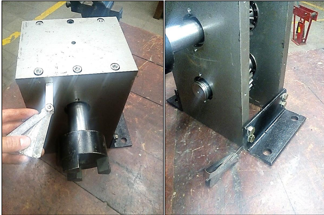
Ilustración 64 Fotografías de la caja de engranajes donde se presenta el ensamblaje y la alineación de los árboles.
