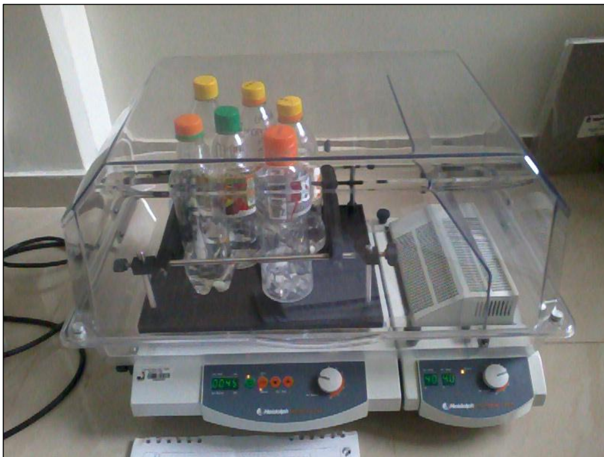
Figura 8. Incubador Heidolph tipo shaker con las muestras de PLLA sumergidas en la solución
