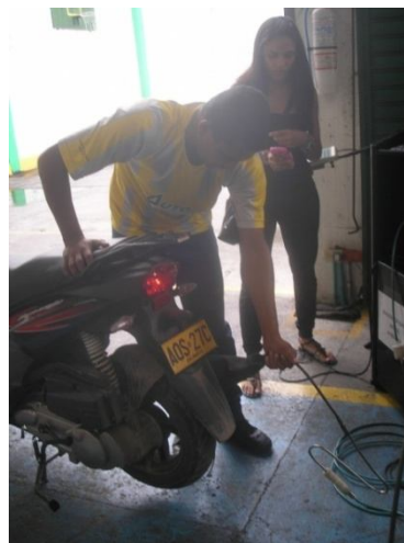
Figura 27: Inspección de gases
