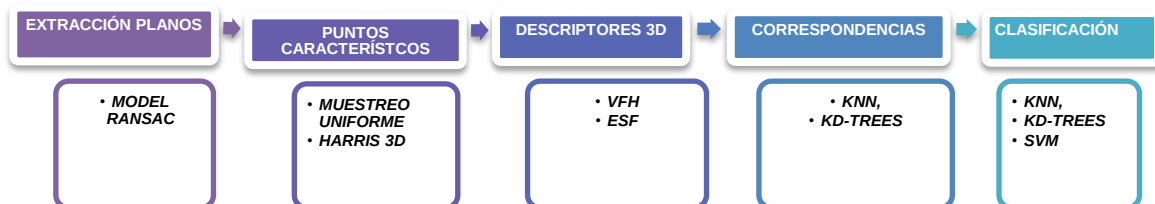
Figura 3.49 Diagrama de bloques de un sistema de clasificación basada en descriptores de tipo global.
