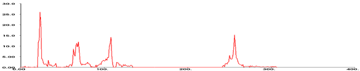
Figura 3.50 Ejemplo del descriptor VFH para un clúster de un vehículo hatchback , se observa la presencia de 308 contenedores en el descriptor VFH, 128 para el componente de punto de vista, 45x3 para los ángulos y 45 para las distancias al centroide.
