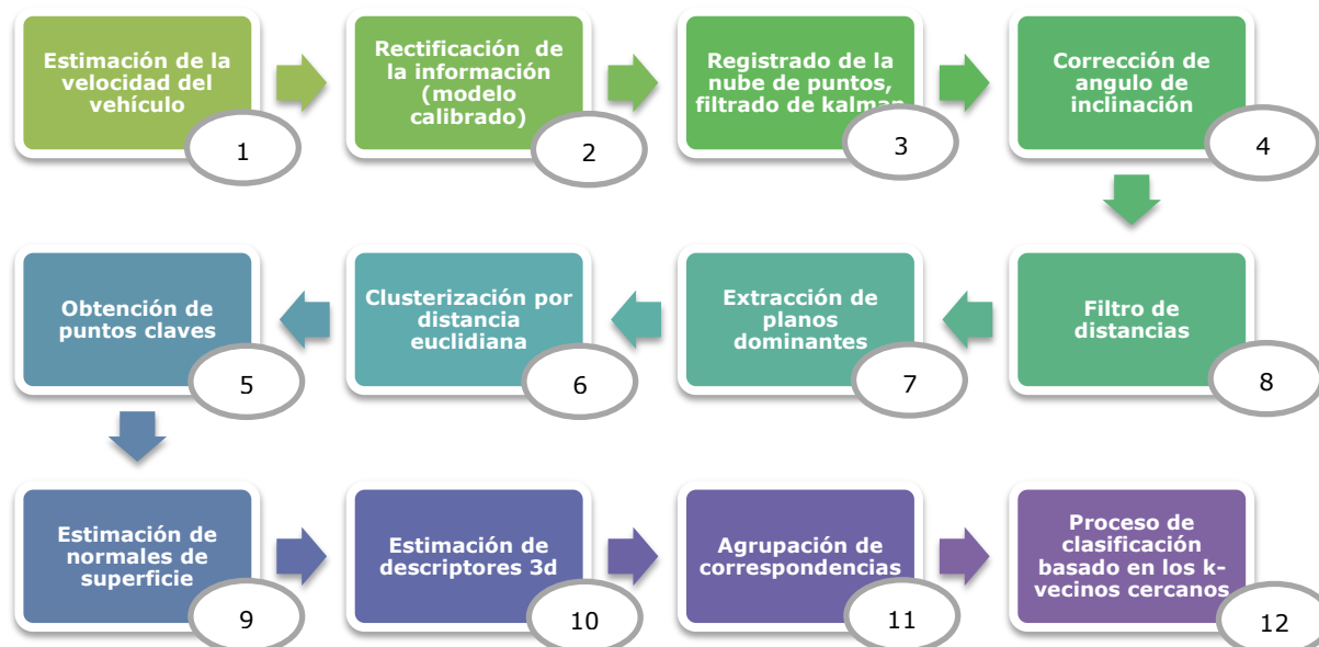
Figura 3.28 Diagrama de bloques del módulo de clasificación basado en información de rango.
