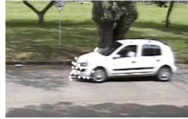
Figura 2.7 Seguimiento de puntos característicos mediante flujo óptico desde el inicio de la secuencia de video –moto de izquierda a derecha- (a) y entre dos fotogramas consecutivos –hatchback de derecha a izquierda- (b). (Imagen tomada en la Universidad del Valle)
