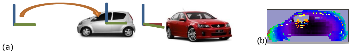
Figura 3.40 a)Traslación al centroide desplazado de la nube de puntos; b)Imagen de rango obtenida mediante la librería PCL, con una resolución de 1 grado por pixel, y un marco de referencia trasladado a el centroide de la imagen ( c_x, c_y, c_z ), más una traslación en el eje x (profundidad, eje perpendicular al lado del carro).
