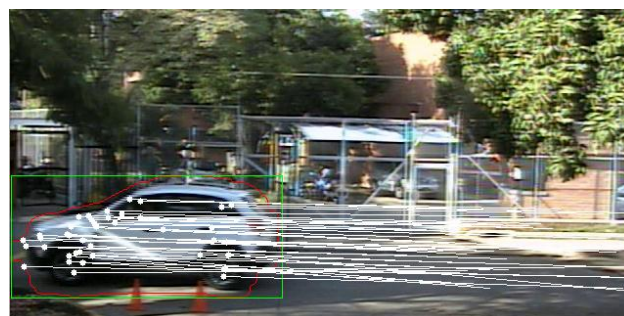
Figura 3.14 Demarcación en el fotograma de entrada de los contornos clasificados como vehículos por medio de una línea roja y un rectángulo verde.
