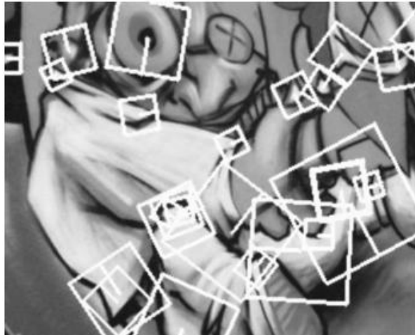
Figura 7.4 Regiones cuadradas corregidas con orientación para puntos representativos SURF (Bay et al., 2008)
