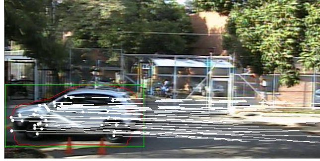
Figura 3.17 Movimiento de cada punto hallado mediante Good Features to Track al interior del blob clasificado como vehículo, desde su posición inicial hasta su posición actual, indicado con las flechas blancas.
