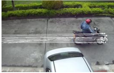
Figura 2.7 Seguimiento de puntos característicos mediante flujo óptico desde el inicio de la secuencia de video –moto de izquierda a derecha- (a) y entre dos fotogramas consecutivos –hatchback de derecha a izquierda- (b). (Imagen tomada en la Universidad del Valle)
