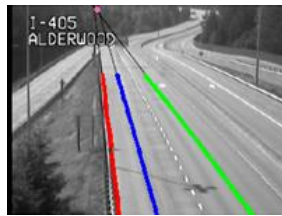
Figura 2.8 Transformación de perspectiva cuando la trayectoria del objeto de interés va en sentido del eje focal de la cámara (Cathey & Dailey, 2005)
