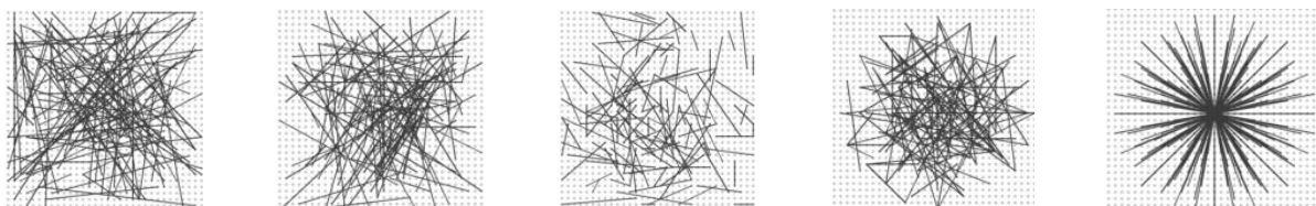
Figura 2.3 Diferentes aproximaciones para escoger las localizaciones de los test binarios. Todos, excepto el de más a la derecha, son muestreos aleatorios. Se muestran 128 tests en cada imagen. (Calonder et al., 2010)
