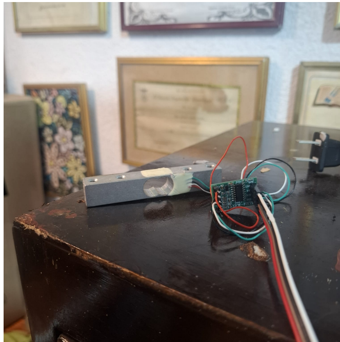
Figura 3.8: Celda y módulo HX711. Propia autoría.
