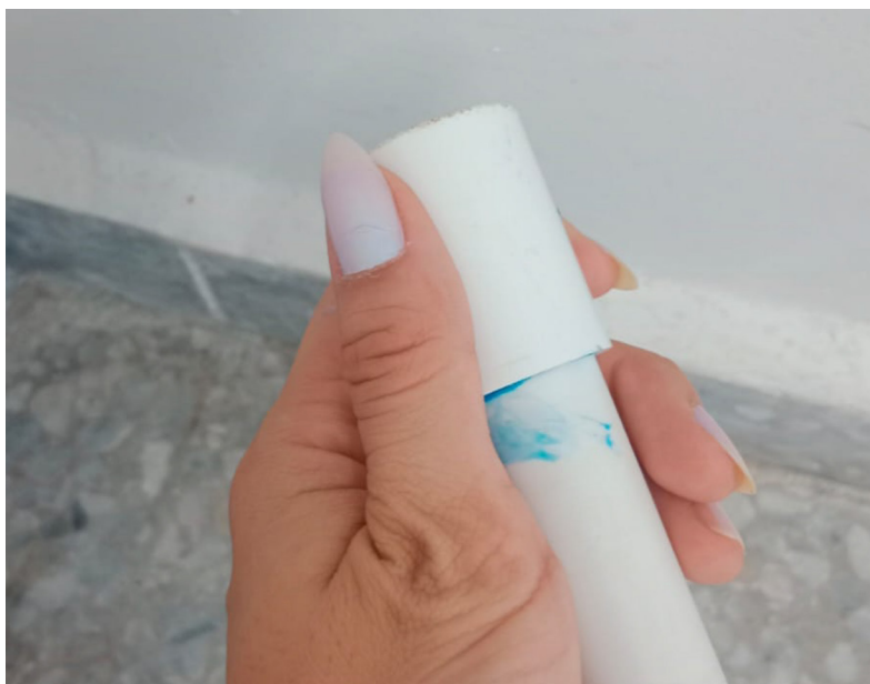
Figura 76. Detalle de la unión fijada con adhesivo para PVC.
