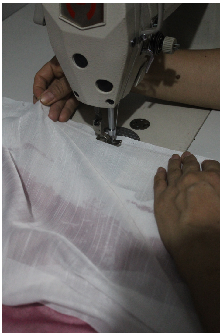
Figura 58. Costura del excedente de los velos impresos.
