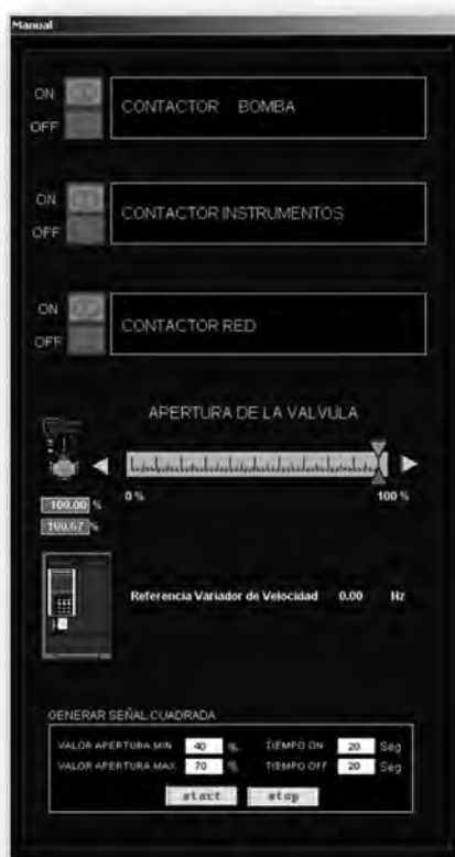
Figura 4.40. Panel operación manual
