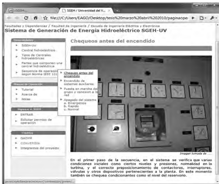
Figura 7.19 Página de secuencia de operación según la norma IEEE 1010, chequeos antes del encendido
