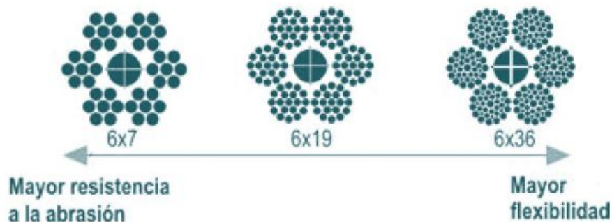
Ilustración 6. Resistencia y Flexibilidad de los Cables. Fuente (SERVICABLES, 2017)
