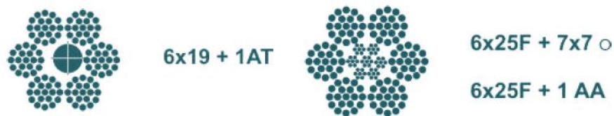
Ilustración 5. Forma constructiva de los cables de acero. Fuente (SERVICABLES, 2017)
