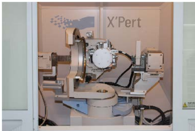
Figura 4.3: Fotografía del equipo de difracción de rayos X de la marca Xpert-Pro de Panalitical la Facultad de Ciencias de la Universidad del Valle.
