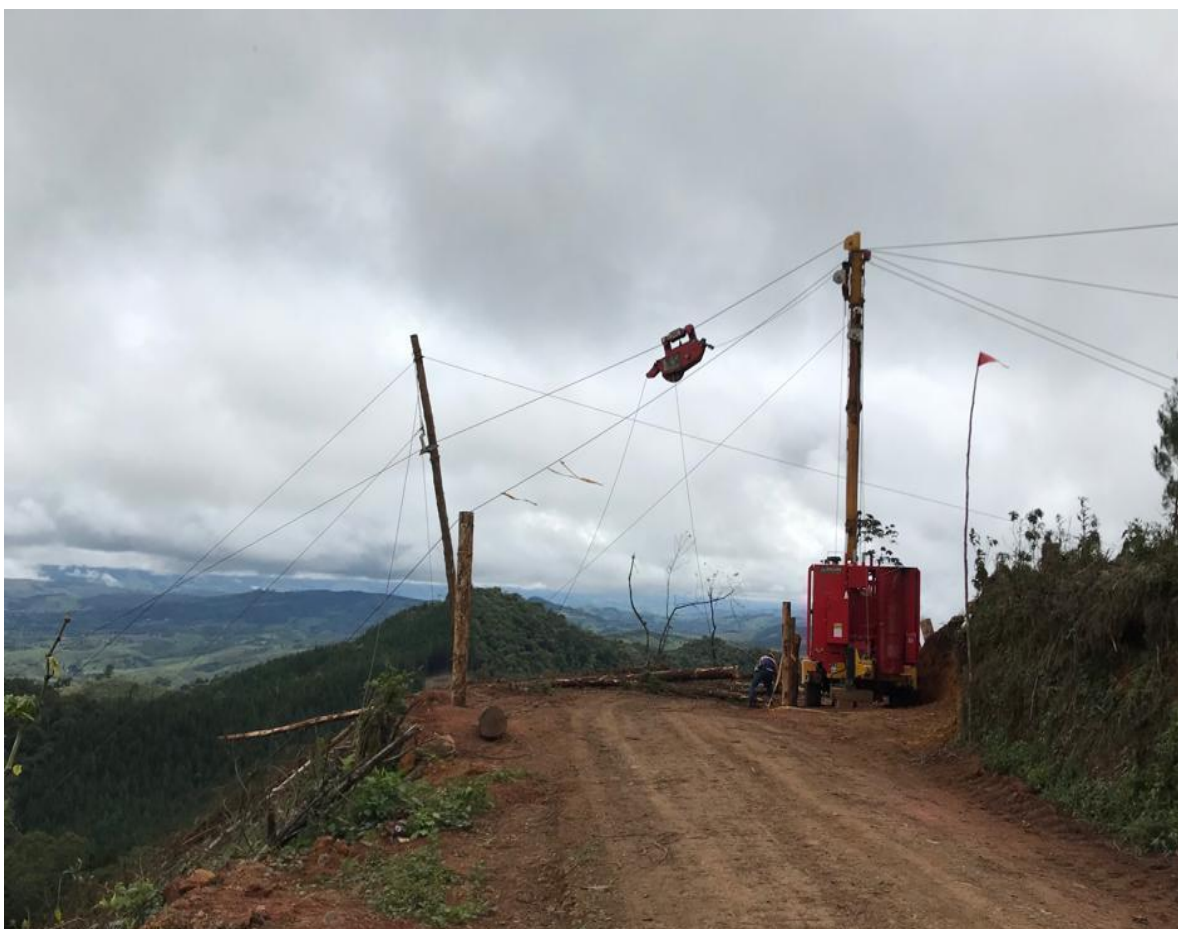
Figura 8. Sistema de saca con cables en proceso de extracción de madera. La Fresneda (03° 45' 08'' N 076° 27' 04'' O). 1.790 msnm. 2022. Foto tomada por los autores.
