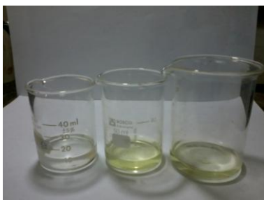
Figura 23. Disolución de 4-clorobenzoato de picrilo en diclorometano, metanol y acetonitrilo de izquierda a derecha respectivamente.
