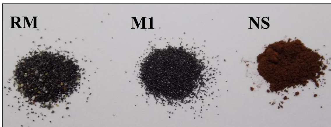
Fig. 5.1. Partículas finas de muestras de mineral. Arenas negras (RM), Concentrado magnético (M1) y material nanoestructurado sintetizado (NS).
