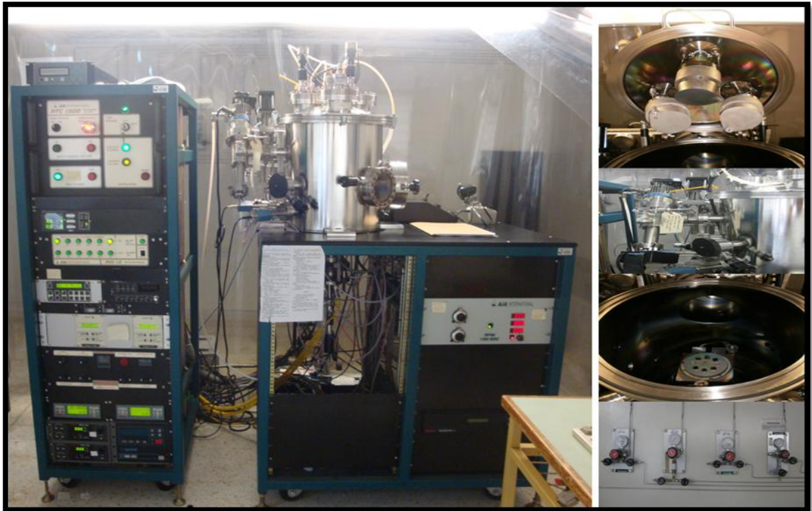
Imagen 4.1. Sistema Magnetron Sputtering – RDAI
