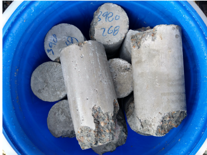
Figura 11. Cilindros testigos después del ensayo de resistencia a la compresión utilizados como material de partida para la producción del AGR. Fuente. Propia
