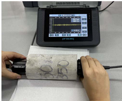
Figura 19. Ensayo de Pulso ultrasónico. Fuente. Propia.
