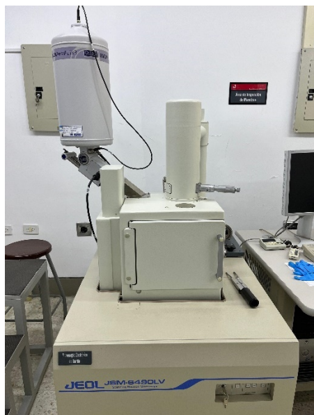
Figura 21. MEB utilizado en la prueba SEM Fuente. Propia
