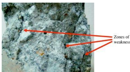
Figura 6. Patrones de grietas de las muestras.
