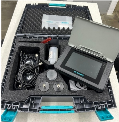
Figura 18. Equipo Pundit Proceq utilizado para el ensayo de pulso ultrasónico Fuente. Propia.
