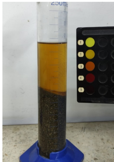
Figura 23. Ensayo de Impurezas orgánicas. Fuente. Propia.
