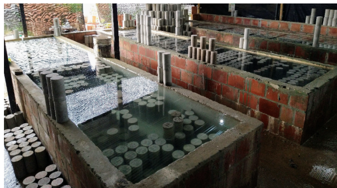
Figura 9. Curado de cilindros en el laboratorio de control de mezclas de la constructora. Fuente. Propia
