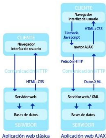
Ilustración 2: Modelo de funcionamiento de una aplicación web AJAX.
