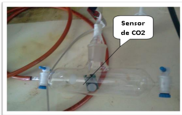
Figura 1. Dispositivo de vidrio en el cual se llevaron a cabo la calibración del sensor de CO 2 con Nitrógeno puro en el laboratorio de ingeniería Química de la Universidad del Valle.
