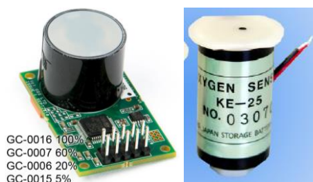
Figura 1. Sensor de CO 2 (izquierda) y sensor de O 2 (derecha)
