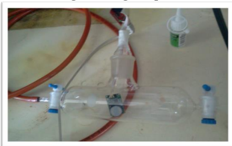
Figura 1. Dispositivo de calibración de sensores.
