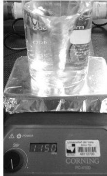
Figura 31 Ejemplo de vórtice generado a 1150 rpm registradas en el visualizador del sistema de agitador electromagnético.
