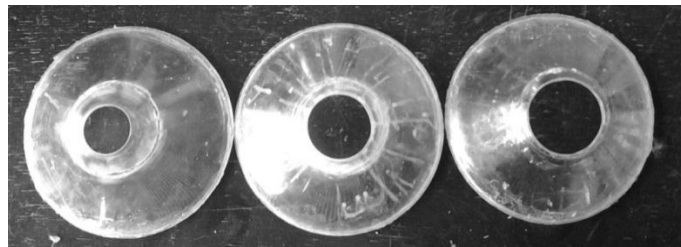
Figura 14 Vista de las tapas de fondo cónico para los dispositivos apreciándose la diferencia en el diámetro de descarga.
