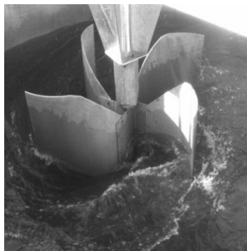
Figura 5 Rotor de una planta hidroeléctrica de vórtice [10].
