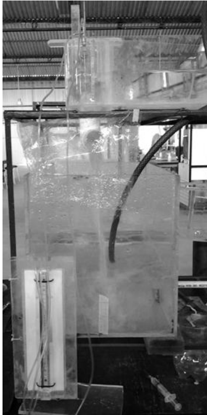
Figura 34 Visualización general de la medición de la deflexión manométrica estimada con el tubo de Pitot.
