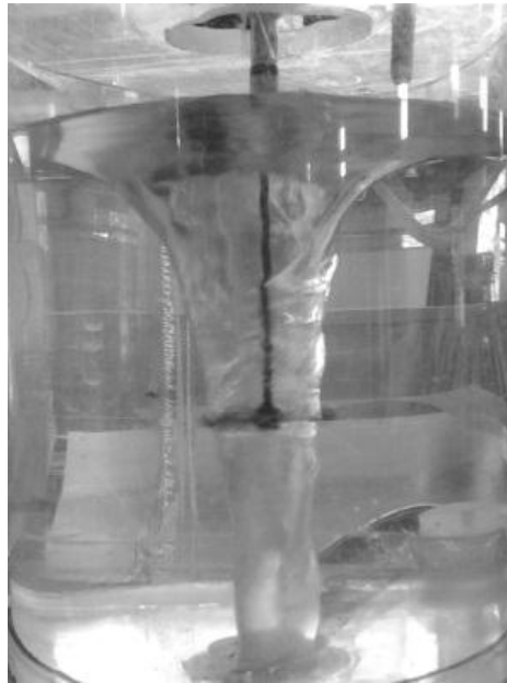
Figura 33 Visualización de un elemento removible determinado en un nivel fijo en el interior del vórtice.
