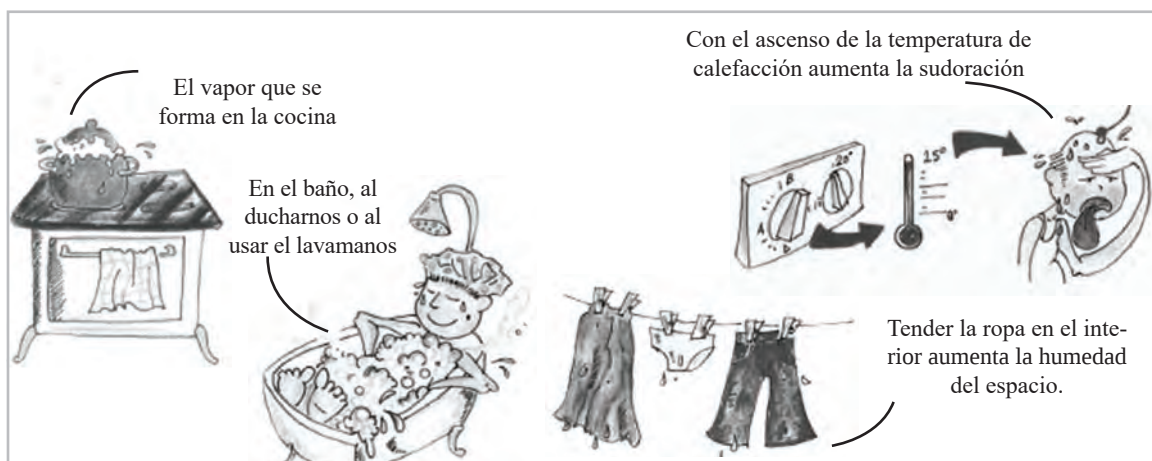
Figura 2.8 Generación de humedad dentro de la casa
