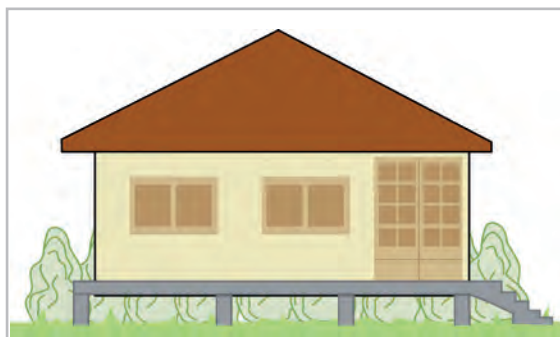
Figura 4.27 Edificación sobre losa elevada del terreno
