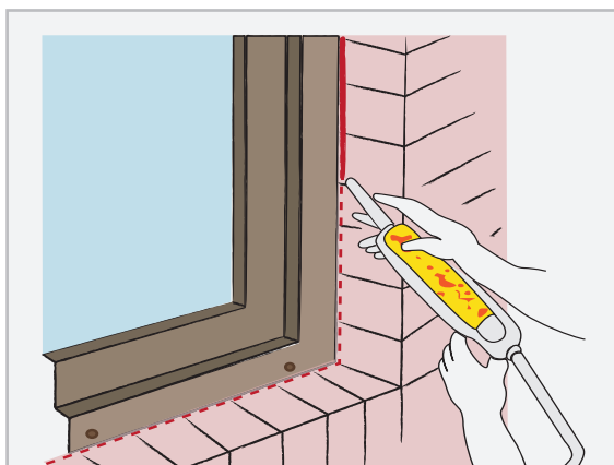
Figura 4.6 Sellado del perímetro de las ventanas
