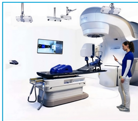
Figura 3: Esquema general del montaje de cámaras y demás componentes del Identify dentro de la sala de tratamiento. Tomado y modificado de “IDENTIFY Operations” [24].
