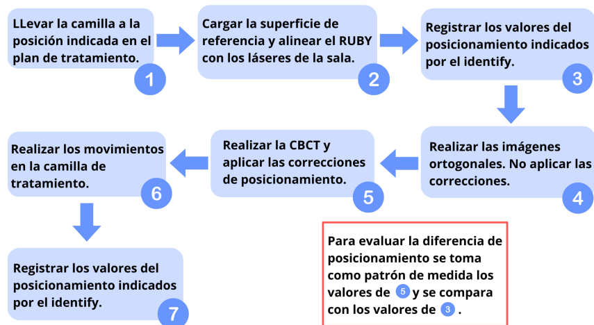
Figura 28: Diagrama de flujo de la prueba de reproducibilidad interfacción.
