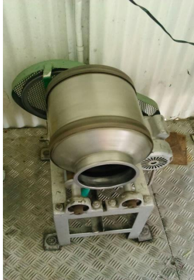
Figura 6. Homogeneizador presente en el laboratorio móvil
