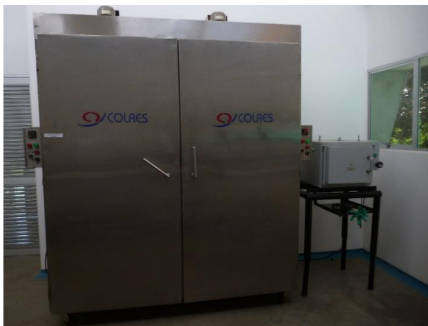
Figura 13. Horno para el secado de muestras.
