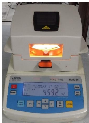
Figura 18. Balanza de humedad utilizada.
