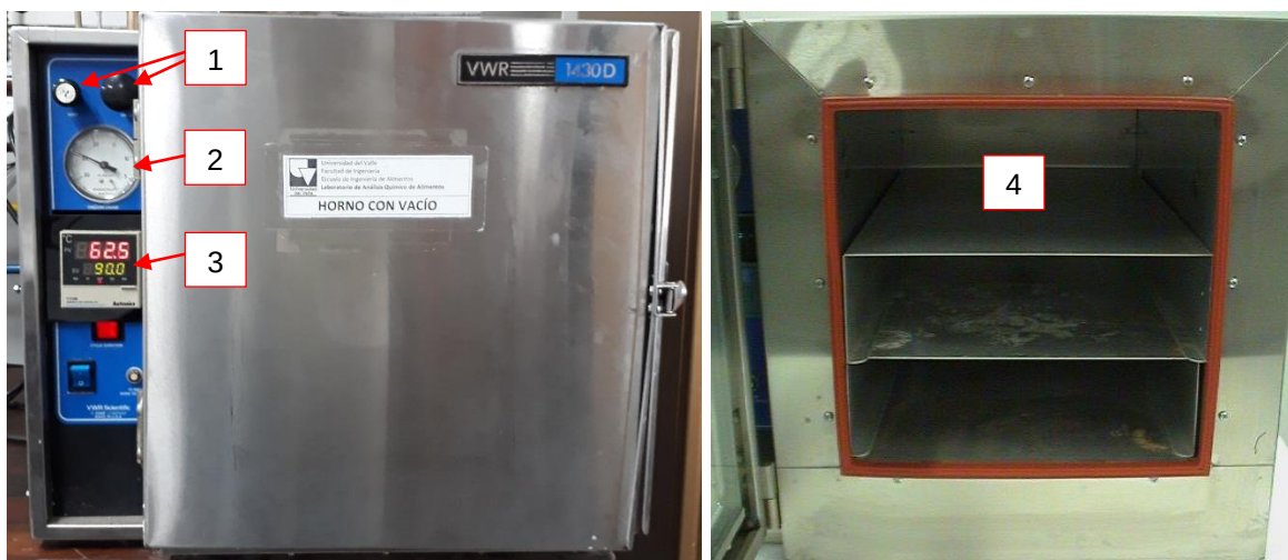
Figura 19. Horno con vacío utilizado.
