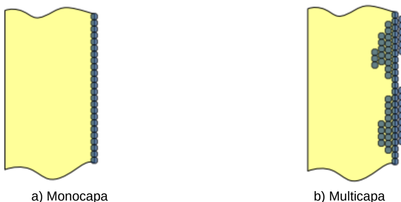
Figura 8. Proceso de adsorción de las moléculas de agua.
