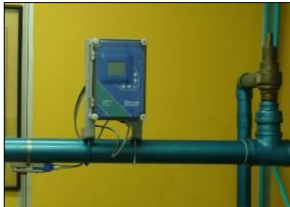
Figura 3.3 Caudalímetro de ultrasonidos Doppler para líquidos Greyline Instruments DFM 5.0
