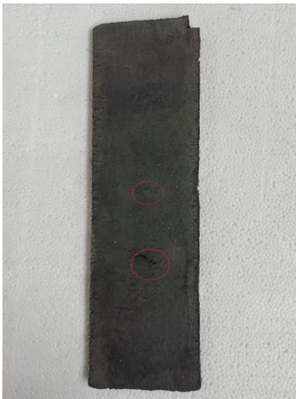
Figura 3.2: Pieza con grietas tras proceso de laminación.
